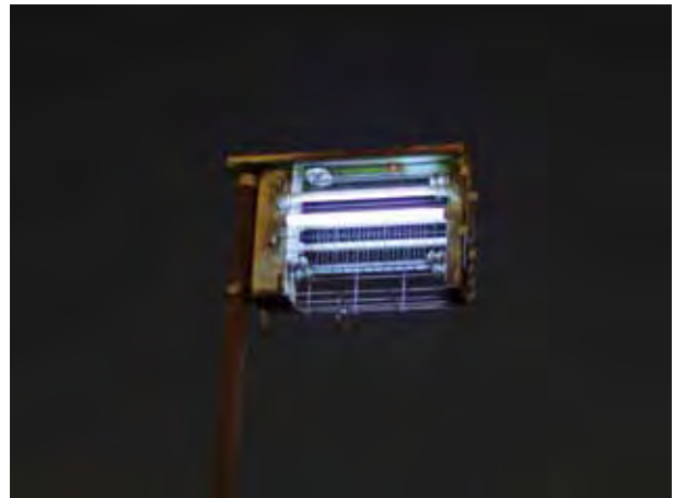
図3 電撃殺虫器の点灯状況。青色蛍光管で、昆虫を引き寄せて本体外側についている金属格子の部分に接触すると感電死する仕組み。
